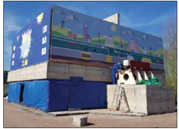
Рисунок 5 – Испытания системы BCS на специальном вибростенде ООО «ЦВС» (г. Санкт-Петербург)
